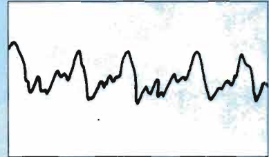
Ecco la forma d'onda del suono emesso dal violino: non è sicuramente sinusoidale ma si può notare una certa regolarità.
